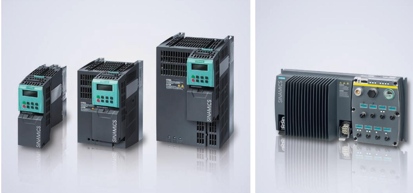
SINAMICS G120 / SINAMICS G120D 變頻器與眾不同之處在於其模組化的設計（電源模組及控制單元），以及許多共通的創新功能，例如安全性技術科技（Safety Integrated）、能量回收及通訊功能。G120 的額定功率範圍 0.37–90 kW (0.5–120 HP) 版本眾多，適用於各種驅動系統解決方案。
